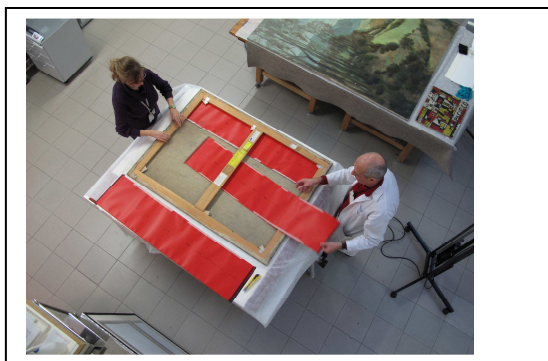
Colocación de las placas radiográficas en la parte trasera de la pintura
